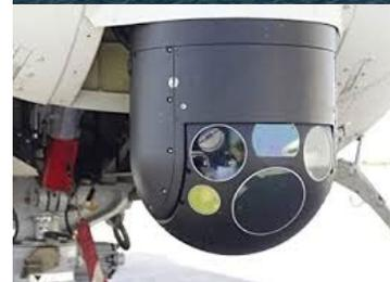
Tecnologie dedicate alla pubblica sicurezza, con capacità di visione termica e illuminazione notturna, riconoscimento targhe, inserimento gruppi intervento speciali, secondarie capacità di evacuazione medica
