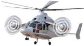
**Airbus X3 - Compound:** portanza prodotta dal rotore principale e dalla porzione di ala, propulsione prodotta dalle eliche (in fase), controllo di imbardata e anti-coppia prodotta dalle eliche (in controfase)
