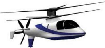
**Sikorsky X2 - coax-compound:** portanza prodotta dai rotori controrotanti, propulsione prodotta dall'elica di coda, controllo di imbardata prodotto dai 2 rotori controrotanti, Nessuna anti-coppia richiesta
