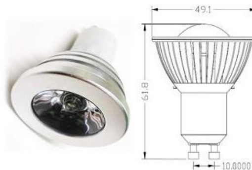
Figura 5 – esempio di lampada con attacco GU10 e relative specifiche (misure in millimetri)
